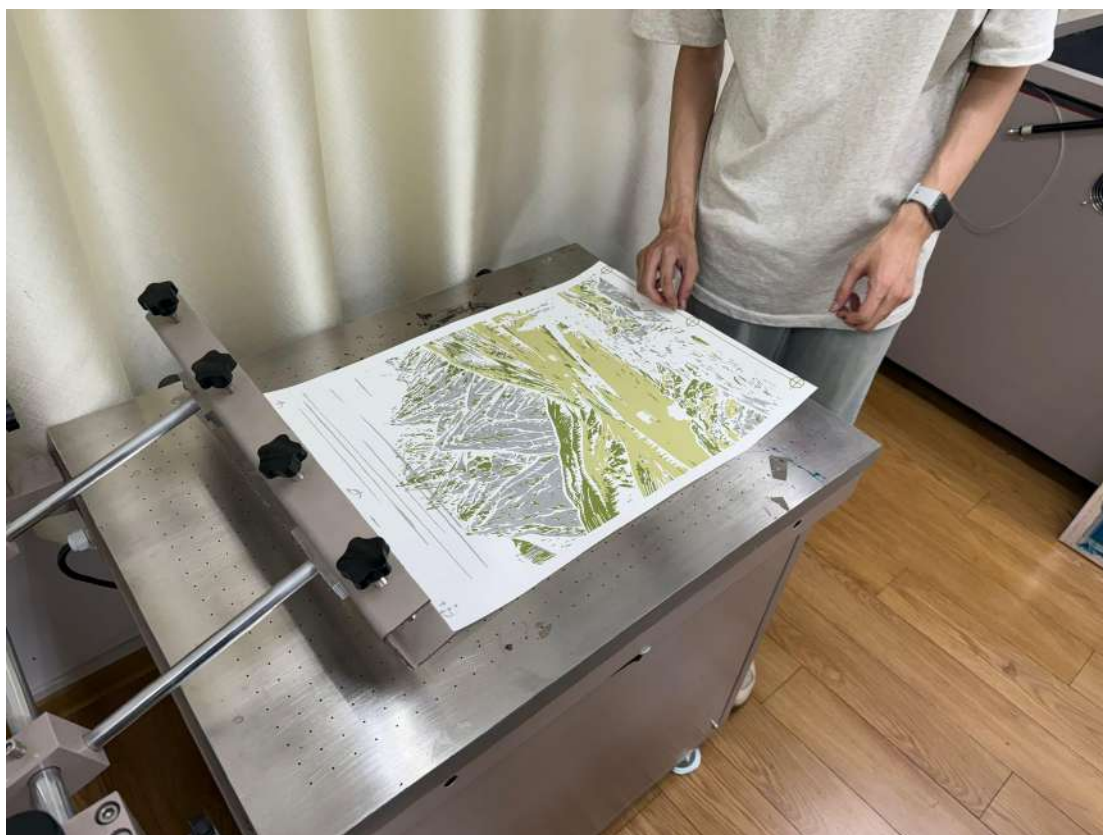
图 77 吸气平台固定纸张
