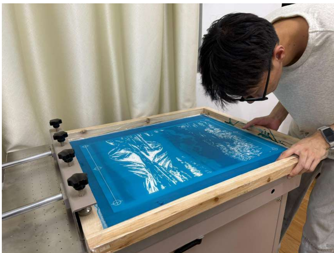
图 79 套色精确定位
