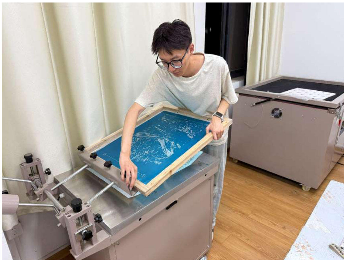
图 78 吸气平台固定网框
